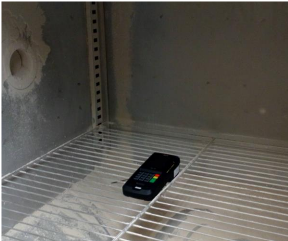
Figür 11: Toz testi kurulumu
