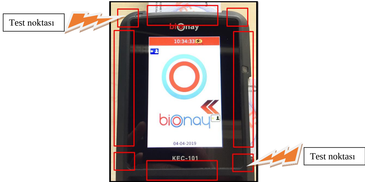
Figure 27: Elektrostatik Deşarj Test Noktalar
