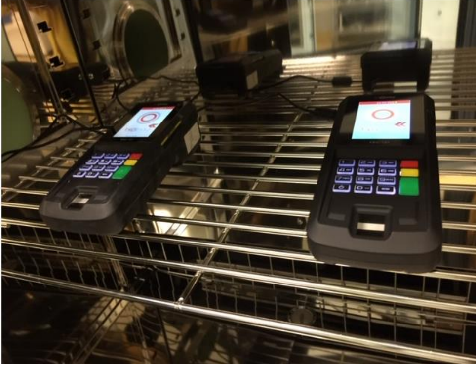
Figür 13: Nemli Isı Testi kurulumu
